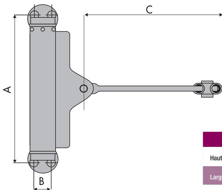
Puissance de fermeture réglable par tension du ressort à l'aide de la broche, en tournant dans le sens de la flèche et en bloquant le ressort à la position désirée avec le goujon d'arrêt.
